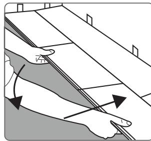
**PASO 4:** Mire el borde largo del tablón insertando la lengüeta en la ranura en ángulo y colóquela en su lugar. Deslice el tablón hacia el extremo del tablón previamente instalado hasta que la lengüeta toque la ranura.
