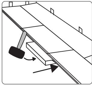
**PASO 5:** ¡Importante! Use un martillo y un taco para golpear el borde largo del tablón para asegurar un ajuste perfecto. ¡Cualquier separación puede comprometer el sistema de bloqueo!
