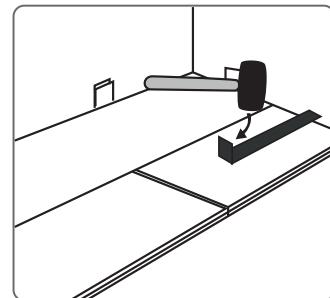
PASO 8: Use un martillo y una barra de tracción para bloquear la pieza final en la fila. Inserte el espaciador al final de la fila. Continúe con la instalación hasta la primera fila.
