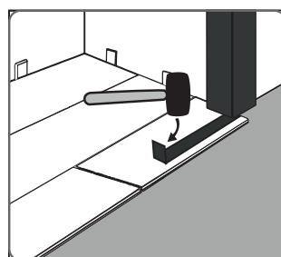
PASO 2: Utilice un martillo y una barra de tracción para bloquear el extremo corto de la tabla.
