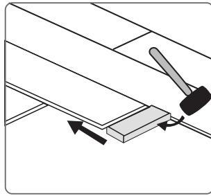
PASO 7: Golpee el extremo del tablón con un martillo y un taco para golpear para unir los extremos de los tablones. Retire el puente y continúe hacia la pared hasta instalar el último tablón en la fila. ASEGÚRESE DE GOLPEAR EL BORDE PARA NO DAÑAR EL SISTEMA CLIC.
